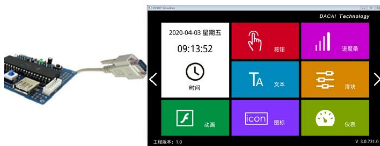
图 8-2 用户单片机串口与“虚拟串口屏”联机调试
